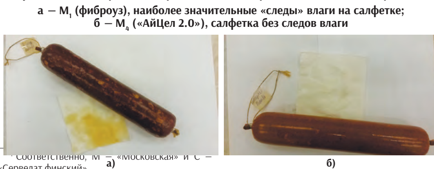
Рисунок 2. Внешний вид образцов колбасы «Московская» после вскрытия упаковки и обтирания поверхности батончиков (рядом с батончиком – салфетка): а – M_1 (фиброуз), наиболее значительные «следы» влаги на салфетке; б – M_4 («АйЦел 2.0»), салфетка без следов влаги
